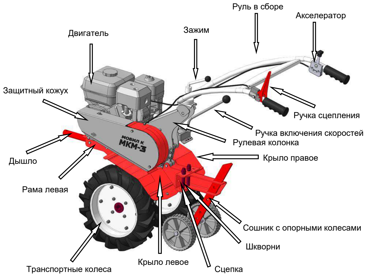
Рис.1. Мотоблок в сборе с транспортными колесами.
